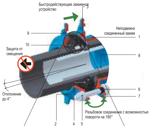
Деталь с неподвижно соединенным зажимом
